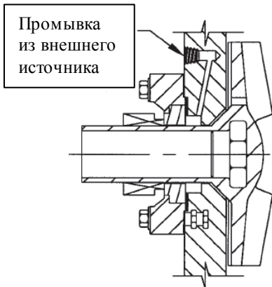
Одиночное внешнее цельное закреплённое седло уплотнения с промывкой из внешнего источника.
